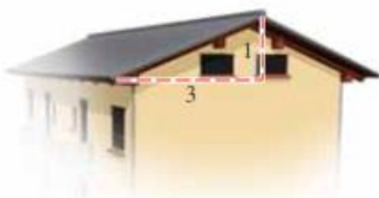
Inclinación de un techo Pendiente = \frac{1}{3}
